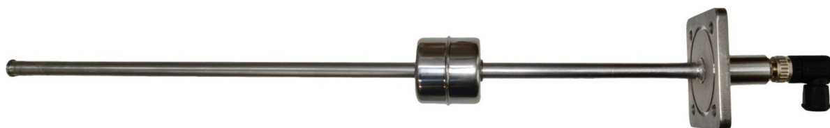
Rys.2. Miernik pływakowy SPP1.
