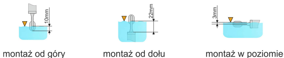
Rys 8. Sposoby zamocowania sygnalizatora WSP-4 i odpowiadające im poziomy przełączania.
